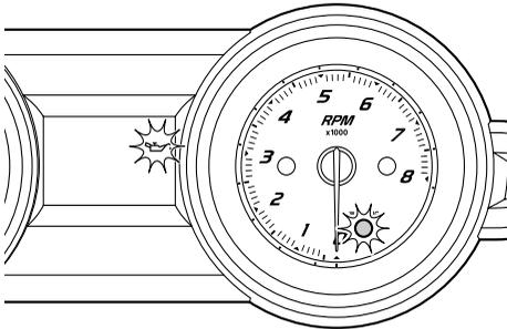
Si l'avertissement de pression d'huile est activé, réduisez immédiatement le régime du moteur, regagnez la rive, puis vérifiez le niveau d'huile moteur. (Cf. page 50 pour plus d'informations sur la vérification du niveau d'huile moteur.) Si le niveau d'huile est suffisant, faites vérifier le scooter nautique par un concessionnaire Yamaha.
