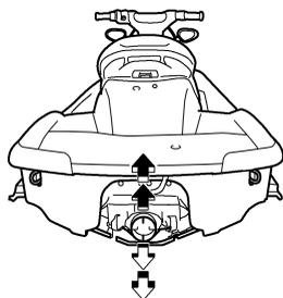
également que l'inverseur remonte ou descend selon le fonctionnement du levier d'inversion et qu'il est en contact avec les butées. (Cf. page 34 pour plus d'informations sur le fonctionnement du système de marche arrière.)
