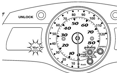
Si l'avertissement de pression d'huile est activé, réduisez immédiatement le régime du moteur, regagnez la rive, puis vérifiez le niveau d'huile moteur. (Cf. page 59 pour plus d'informations sur la vérification du niveau d'huile moteur.) Si le niveau d'huile est suffisant, faites vérifier le scooter nautique par un concessionnaire Yamaha.
