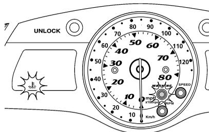
Si l'avertissement de surchauffe du moteur est activé, réduisez immédiatement le régime du moteur, regagnez la rive, puis vérifiez que l'eau s'évacue par la sortie témoin d'eau de refroidissement située à bâbord (gauche) lorsque le moteur tourne. En l'absence d'écoulement d'eau, arrêtez le moteur et vérifiez si l'entrée de la tuyère n'est pas obstruée.
