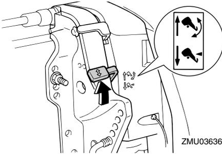
4. Maintenez l'arrière du capot supérieur d'une main, relevez le moteur et tournez le levier de support de relevage vers vous ou enfoncez le bouton support de relevage dans le support de fixation, puis ramenez le levier de verrouillage du système de relevage en position verrouillée pour soutenir le moteur hors-bord.
