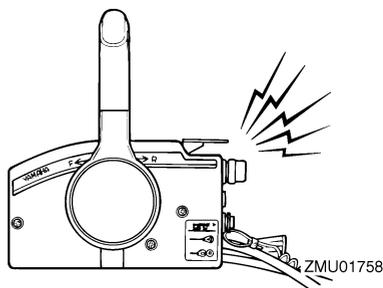
Si le système d'avertissement est activé, arrêtez le moteur aussi rapidement que votre sécurité le permet. Vérifiez le niveau d'huile et ajoutez de l'huile si nécessaire. Si le niveau d'huile est correct et que le dispositif
