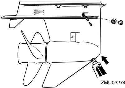
6. Lorsque l'huile commence à s'écouler par l'orifice de la vis de niveau d'huile, insérez et serrez la vis de niveau d'huile.
