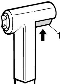
1. Commande de verrouillage de point mort
