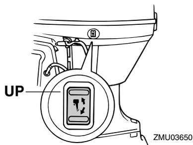
3. Pour ramener le moteur hors-bord à sa position de fonctionnement normale, appuyez sur l'interrupteur de trim et abaissez légèrement le moteur hors-bord.
