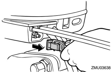
3. Appuyez sur l'interrupteur de trim / relevage assisté "UP" (relever) jusqu'à ce que le moteur hors-bord soit complètement relevé.
