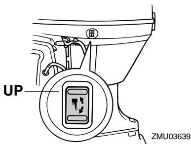
4. Enfoncez le bouton support de relevage dans le support de fixation ou tirez le levier support de relevage vers vous pour soutenir le moteur.
