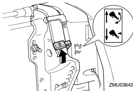
2. Maintenez l'arrière du capot supérieur d'une main, relevez légèrement le moteur hors-bord et tirez le bouton support de relevage ou ramenez le levier de support de relevage.
