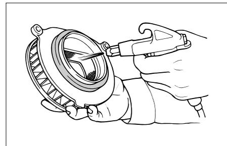
4. Tapoter l'élément de sorte à enlever le gros de la crasse, puis éliminer le reste des impuretés à l'air comprimé en procédant comme illustré. Remplacer l'élément du filtre à air si celui-ci est endommagé.
