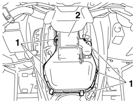
1. Attache du couvercle du boîtier de filtre à air
