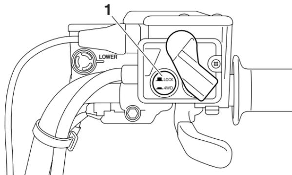
1. Commutateur de blocage du différentiel "4WD"/"LOCK"
