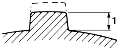
1. Limite d'usure de pneu
