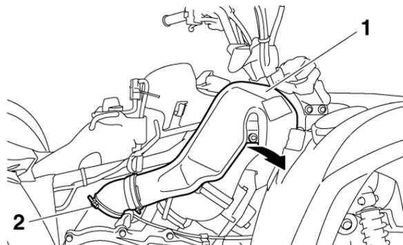
1. Conduit de refroidissement de la courroie trapézoïdale
