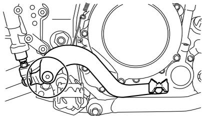
Contrôler le fonctionnement de la pédale de frein avant chaque départ et lubrifier l'articulation de la pédale quand nécessaire.
