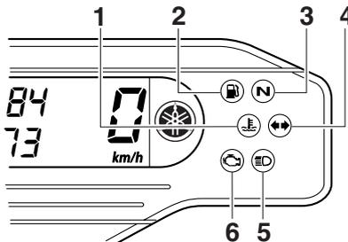
1. Témoin d'alerte de la température du liquide de refroidissement "🌡️"
