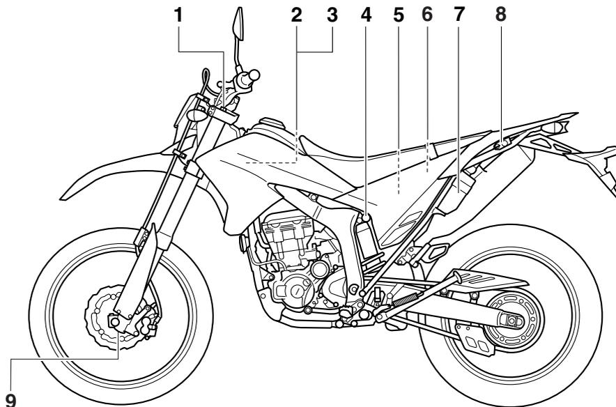
1. Vis de réglage de la force d'amortissement à la détente de la fourche (page 3-15)
