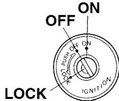
Le contacteur à clé/antivol commande les circuits d'allumage et d'éclairage et permet de bloquer la direction. Ses diverses positions sont décrites ci-après.
