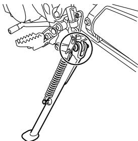
Contrôler le fonctionnement de la béquille latérale avant chaque départ et lubrifier son articulation et les points de contact des surfaces métalliques quand nécessaire.
