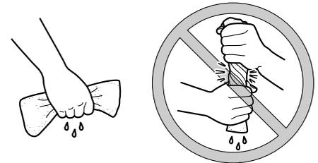
5. Enduire toute la surface de l'élément en mousse d'huile du type recommandé, puis éliminer l'excès d'huile en comprimant l'élément.
