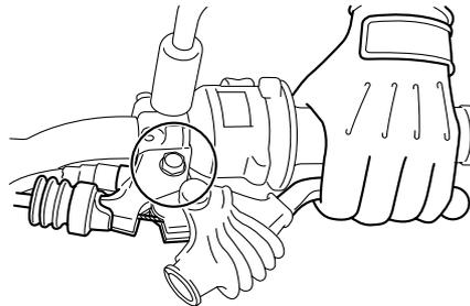
Contrôler le fonctionnement des leviers de frein et d'embrayage avant chaque départ et lubrifier les articulations de levier quand nécessaire.
