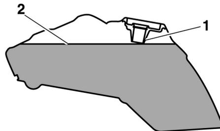
1. Tube de remplissage du réservoir de carburant
