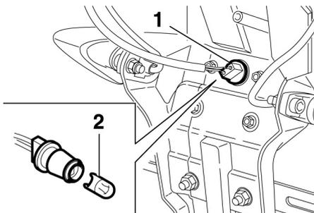
1. Douille d'ampoule d'éclairage de la plaque d'immatriculation
