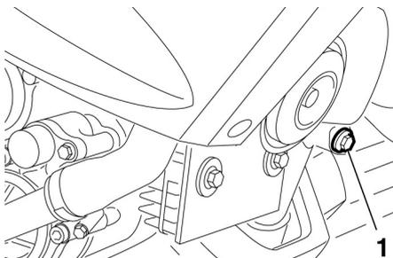
1. Vis de vidange d'huile moteur (réservoir d'huile)
