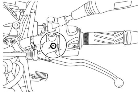
Contrôler le fonctionnement des leviers de frein et d'embrayage avant chaque départ et lubrifier les articulations de levier quand nécessaire.
