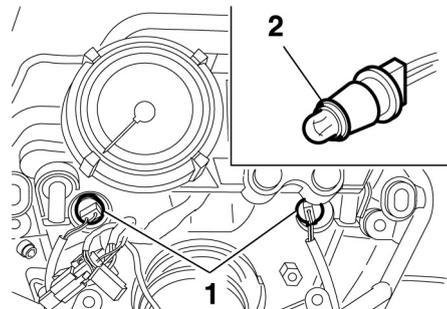
1. Douille d'ampoule de veilleuse
