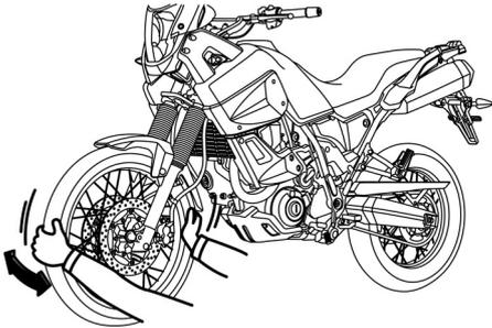
Contrôler les roulements de roue avant et arrière aux fréquences spécifiées dans le tableau des entretiens et graissages périodiques. Si le moyeu de roue a du jeu ou si la roue ne tourne pas régulièrement, faire contrôler les roulements de roue par un concessionnaire Yamaha.
