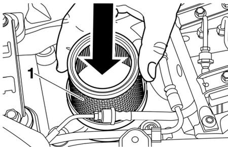
1. Contrôler si le tube de vidange, situé sur le côté du boîtier de filtre à air, contient de l'eau ou des crasses.
