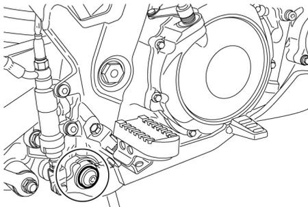
6 Contrôler le fonctionnement de la pédale de frein avant chaque départ et lubrifier l'articulation de la pédale quand nécessaire.
