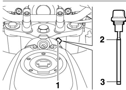
1. Bouchon de remplissage de l'huile moteur
