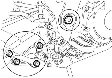
Faire lubrifier les articulations de la suspension arrière par un concessionnaire Yamaha aux fréquences spécifiées dans le tableau des entretiens et graissages périodiques.
