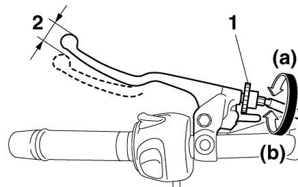
1. Vis de réglage de la garde du levier d'embrayage
