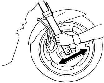
**Contrôle des roulements de roue**
