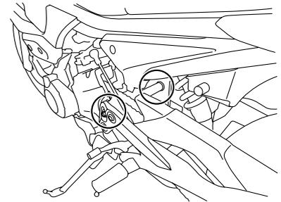
Contrôler les pivots du bras oscillant aux fréquences spécifiées dans le tableau des entretiens et graissages périodiques.
