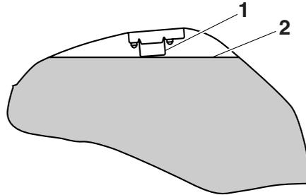
1. Tube de remplissage du réservoir de carburant
