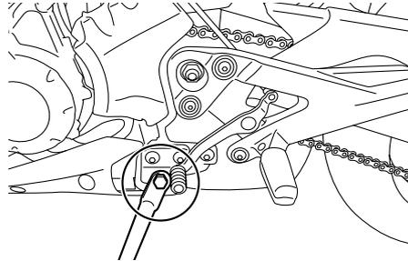
Contrôler le fonctionnement de la béquille latérale avant chaque départ et lubrifier son articulation et les points de contact des surfaces métalliques quand nécessaire.
