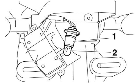
1. Douille d'ampoule d'éclairage de la plaque d'immatriculation
