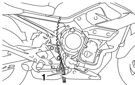
1. Durite de mise à l'air/de trop-plein du réservoir de carburant
