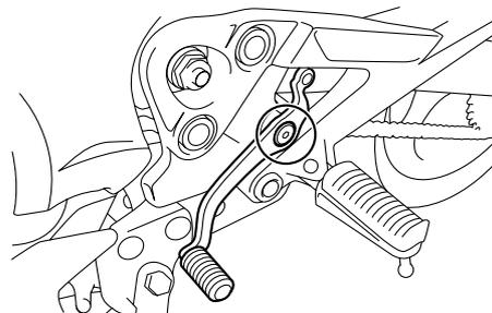
Contrôler le fonctionnement de la pédale de frein et du sélecteur avant chaque départ et lubrifier les articulations quand nécessaire.
