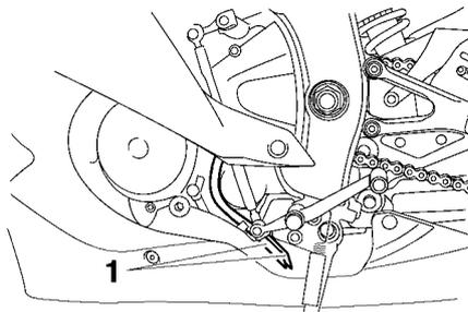
1. Durite de mise à l'air du réservoir de carburant et durite de trop-plein
