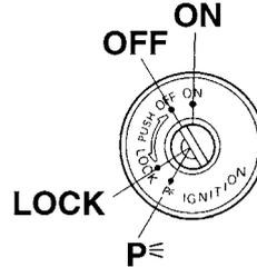
Le contacteur à clé/antivol commande les circuits d'allumage et d'éclairage et permet de bloquer la direction. Ses diverses positions sont décrites ci-après.
