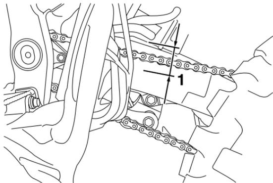
1. Tension de la chaîne de transmission
