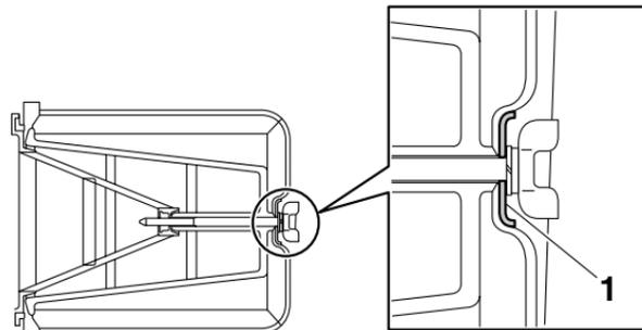
1. Siège de l'élément du filtre à air
