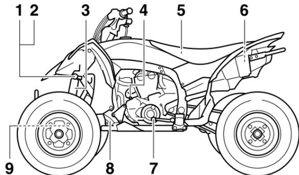
9. Vis de réglage de la force d'amortissement à la détente de combiné ressort-amortisseur avant
