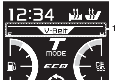
1. Indicateur de remplacement de la courroie trapézoïdale "V-Belt"
