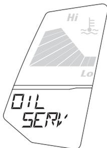
La fonction de message d'alerte est associée à l'afficheur du niveau de carburant, à l'afficheur de la température du liquide de refroidissement, à l'indicateur de changement d'huile et à l'indicateur de batterie faible, et affiche un message d'alerte correspondant. Si plusieurs messages d'alerte surviennent, l'affichage change comme suit :
