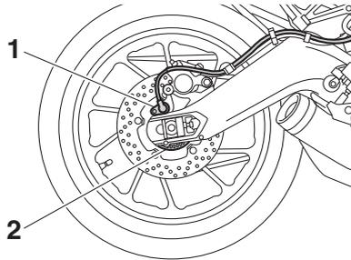
1. Capteur de roue arrière
