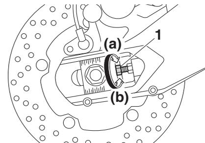
1. Vis de réglage de la tension de la chaîne de transmission
