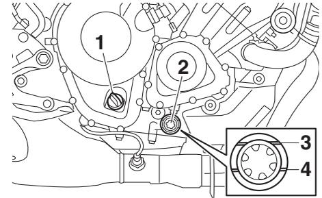
1. Bouchon de remplissage de l'huile moteur
