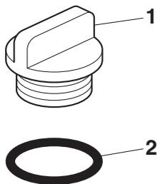
1. Bouchon de remplissage de l'huile moteur
