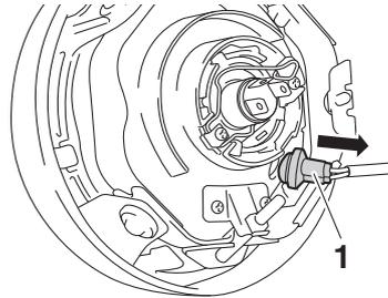
1. Douille d'ampoule de veilleuse
