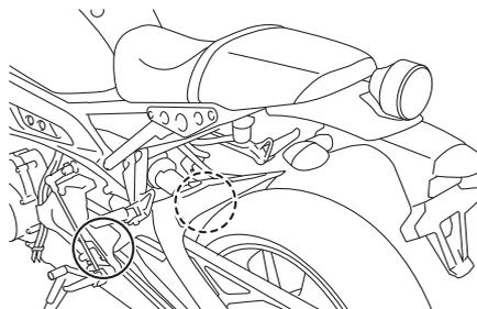
Faire contrôler les pivots du bras oscillant par un bras oscillant aux fréquences spécifiées dans le tableau des entretiens et graissages périodiques.
