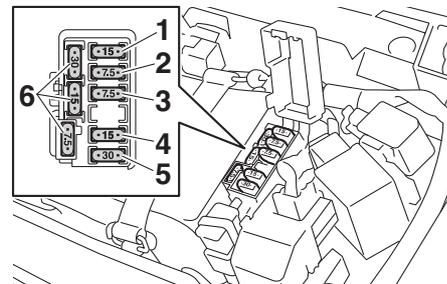
1. Fusible du moteur du ventilateur de radiateur
