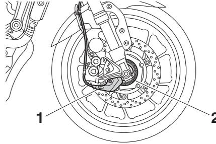
1. Capteur de roue avant
