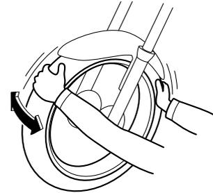
Contrôler les roulements de roue avant et arrière aux fréquences spécifiées dans le tableau des entretiens et graissages périodiques. Si le moyeu de roue a du jeu ou si la roue ne tourne pas régulièrement, faire contrôler les roulements de roue par un concessionnaire Yamaha.
