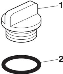
1. Bouchon de remplissage de l'huile moteur
