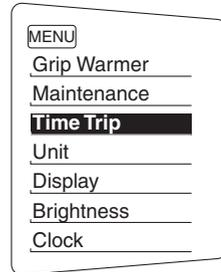
2. Appuyer sur le contacteur "MENU" pour afficher "TIME-2" et "TIME-3". Pour remettre un totalisateur journalier à zéro, appuyer sur le bouton "RESET" pour sélectionner l'élément à remettre à zéro.
