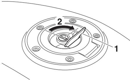
1. Cache-serrure du bouchon de réservoir de carburant
