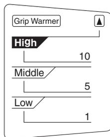
3. Appuyer sur le contacteur "MENU". Le niveau de température du réglage élevée commence à clignoter. Appuyer sur le contacteur de sélection pour régler le niveau de température, puis appuyer sur le contacteur "MENU". "High" se met à clignoter.
