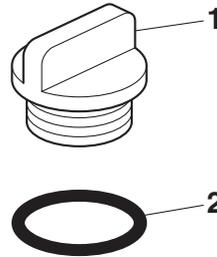
1. Bouchon de remplissage de l'huile moteur
