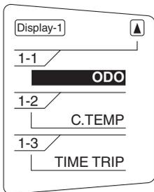
5. Une fois la modification des réglages terminée, utiliser le contacteur de sélection pour mettre "ODO" en surbrillance, puis appuyer sur le contacteur "MENU" pour revenir à l'affichage précédent.
