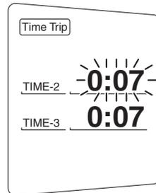
3. Alors que l'élément sélectionné clignote, appuyer pendant au moins 2 secondes sur le bouton "RESET".
