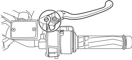
Contrôler le fonctionnement du levier de frein avant chaque départ et lubrifier l'articulation du levier quand nécessaire.
