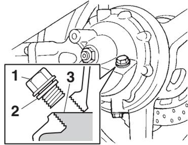
1. Bouchon de remplissage d'huile de couple conique arrière
