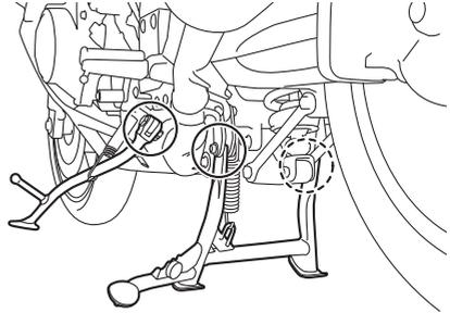
Contrôler le fonctionnement des béquilles centrale et latérale avant chaque départ et lubrifier les articulations et les points de contact des surfaces métalliques quand nécessaire.
