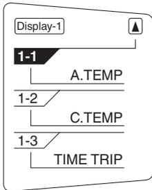
4. Utiliser le contacteur de sélection pour choisir l'élément à afficher, puis appuyer sur le contacteur "MENU".
