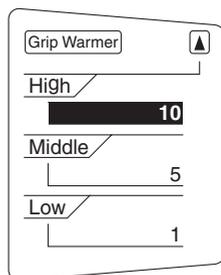
4. Utiliser le contacteur de sélection pour mettre "Middle" ou "Low" en surbrillance, puis changer le réglage en respectant la même procédure que pour le réglage précédent (High).
