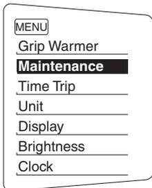
2. Appuyer sur le contacteur "MENU", puis sur le bouton "RESET" pour sélectionner l'élément à remettre à zéro.
