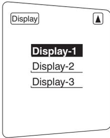
3. Utiliser le contacteur de sélection pour mettre en surbrillance l'élément à modifier, puis appuyer sur le contacteur "MENU".
