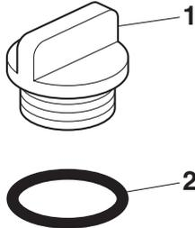
1. Bouchon de remplissage de l'huile moteur
