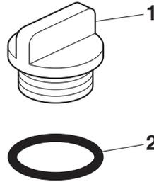
1. Bouchon de remplissage de l'huile moteur
