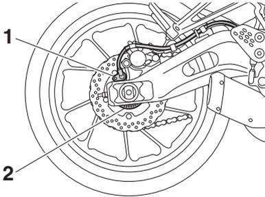
1. Capteur de roue arrière
