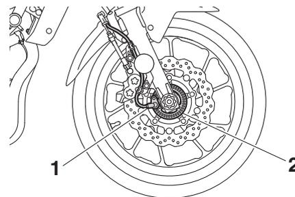
1. Capteur de roue avant
