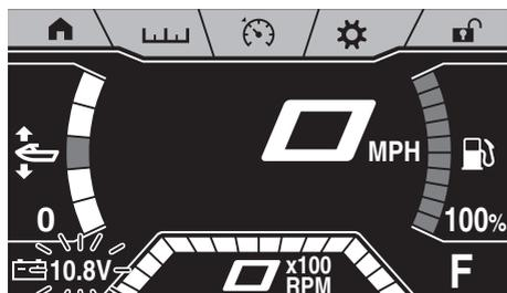
Si l'avertissement de tension de batterie est activé, faites vérifier le scooter nautique par un concessionnaire Yamaha le plus rapidement possible.
